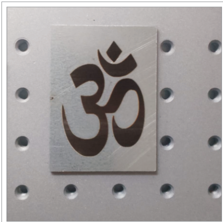
Galvanized Iron (GI)
